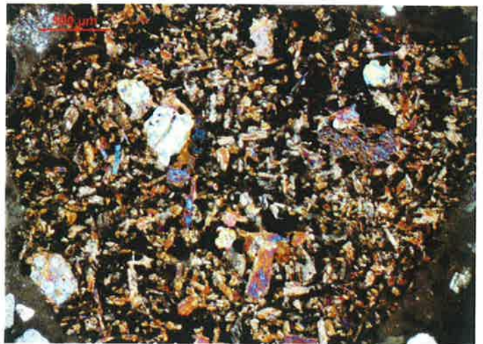
Fot. 18. Próbką 1118/19 – dolna warstwa betonu; ziarno bazaltu; obraz mikroskopowy w świetle przechodzącym spolaryzowanym (skrzyżowane polaryzatory) [7]
