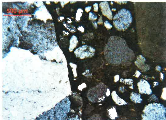
Fot. 9. Próbką 1124/19 – górna warstwa betonu; widoczne ziarna piasku i żwiru; obraz mikroskopowy w świetle przechodzącym spolaryzowanym (skrzyżowane polaryzatory) [7]
