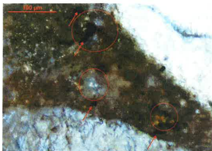
Fot. 22. Próbką 42/20 – górna warstwa betonu; stwardniały zaczyn cementowy (brązowy) z relikami niezhydratyzowanych ziaren cementu (okręgi) i skupieniami czarnego brownmillerytu (strzałki); obraz mikroskopowy w świetle przechodzącym spolaryzowanym (skrzyżowane polaryzatory) [7]
