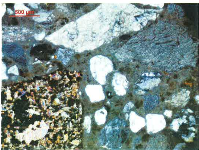
Fot. 8. Próbką 1118/19 – dolna warstwa betonu; widoczne ziarna piasku, żwiru i bazaltu (lewy dolny róg); obraz mikroskopowy w świetle przechodzącym spolaryzowanym (skrzyżowane polaryzatory) [7]
