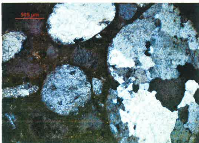
Fot. 11. Próbką 42/20 – górna warstwa betonu; widoczne ziarna piasku i żwiru; obraz mikroskopowy w świetle przechodzącym spolaryzowanym (skrzyżowane polaryzatory) [7]
