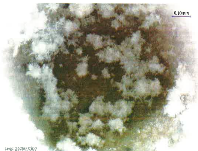
Fot. 29. Próbką 1118/19 – górna warstwa betonu, widoczny por powietrzny z mineralizacją (być może ettringit) na ściankach [7]
